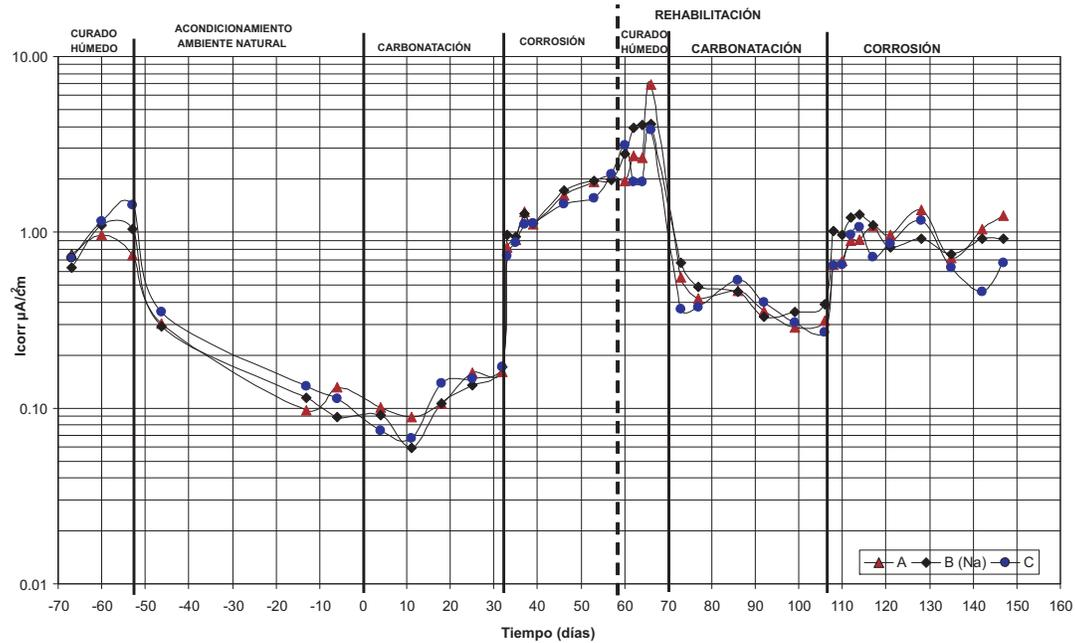
Figura 2. Promedio de densidades de corriente de corrosión.
