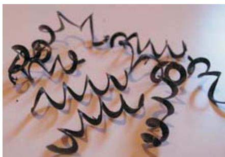
Figura 9. Tipos de virutas obtenidas: (a) para 200 m/min. y (b) para 240 m/min.
