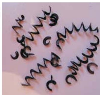
Figura 10. Tipos de virutas obtenidas para Vc = 280 m/min: (a) para T = 1,3 min, (b) para T = 3,5 min y (c) para T = 7,7 min.
