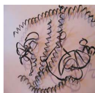
Figura 10. Tipos de virutas obtenidas para Vc = 280 m/min: (a) para T = 1,3 min, (b) para T = 3,5 min y (c) para T = 7,7 min.
