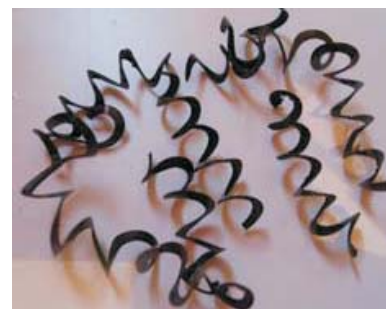
Figura 9. Tipos de virutas obtenidas: (a) para 200 m/min. y (b) para 240 m/min.
