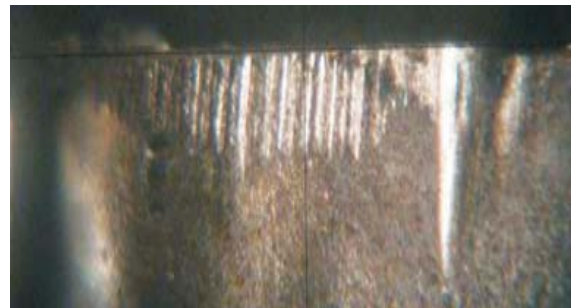
Figura 5. Desgaste de la herramienta para V_c= 240\text{m/min} .
