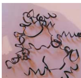
Figura 10. Tipos de virutas obtenidas para Vc = 280 m/min: (a) para T = 1,3 min, (b) para T = 3,5 min y (c) para T = 7,7 min.
