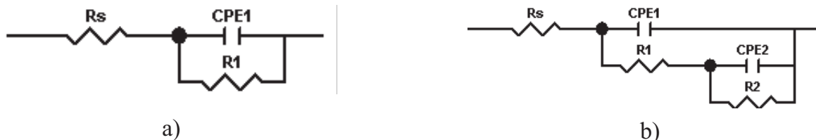
Figura 5. Circuito equivalente. a) Circuito para ajustar los datos de impedancia del sustrato; b) Circuito para ajustar los datos de impedancia de los recubrimientos con las modificaciones del bias.
