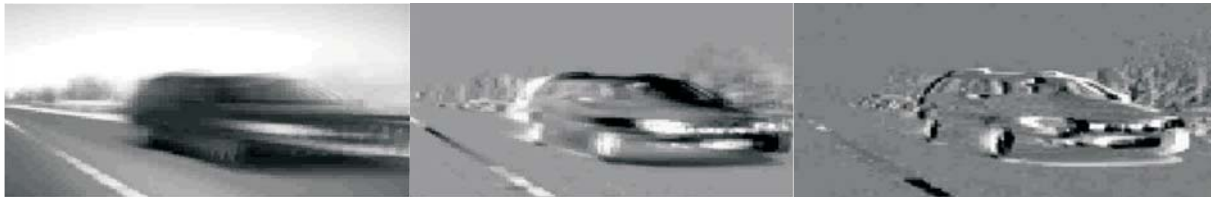
Figura 3. Resultados de los filtros recursivos a una secuencia de adelantamiento de vehículos. De izquierda a derecha, derivadas de orden 0, 1, 2. Secuencia de entrada proporcionada por HELLA [24].
