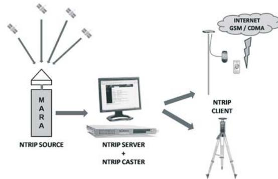
Figura 3. Configuración del NTRIP en la estación Maracaibo.
