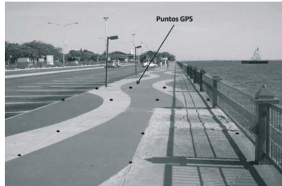
Figura 8. Levantamiento GPS-NTRIP de aceras en el parque Vereda del Lago.
