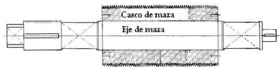
Figura 2. Maza y eje de maza.
