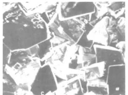
Figura 11c. Cristales de \text{FeCO}_3 y formación de pequeños cristales de \text{CaCO}_3 a 150^{\circ}\text{C}
