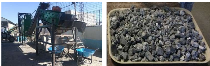
Figura 2. Trituradora modelo LEM 4825 empleada y muestra de la escoria triturada.
