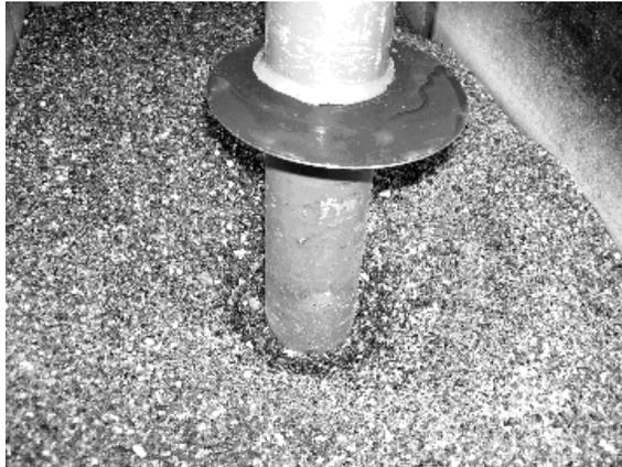
Figura 5. Ubicación del aro excéntrico a una cierta distancia del fondo y foso de socavación.
