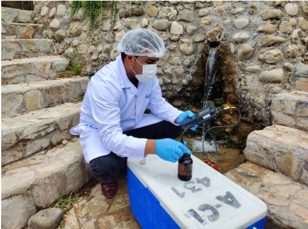
**Figura 5.** Evaluación de la conductividad y salinidad en el Punto 03 Zona de acceso a la población, desviación por escalinatas y conductos artificiales.
