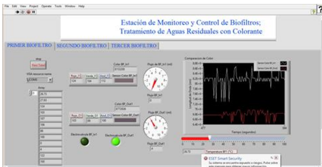
Figura 3a. Comparación de agua residual de Entrada (color blanco) y agua residual de salida del biofiltro (color rojo).
