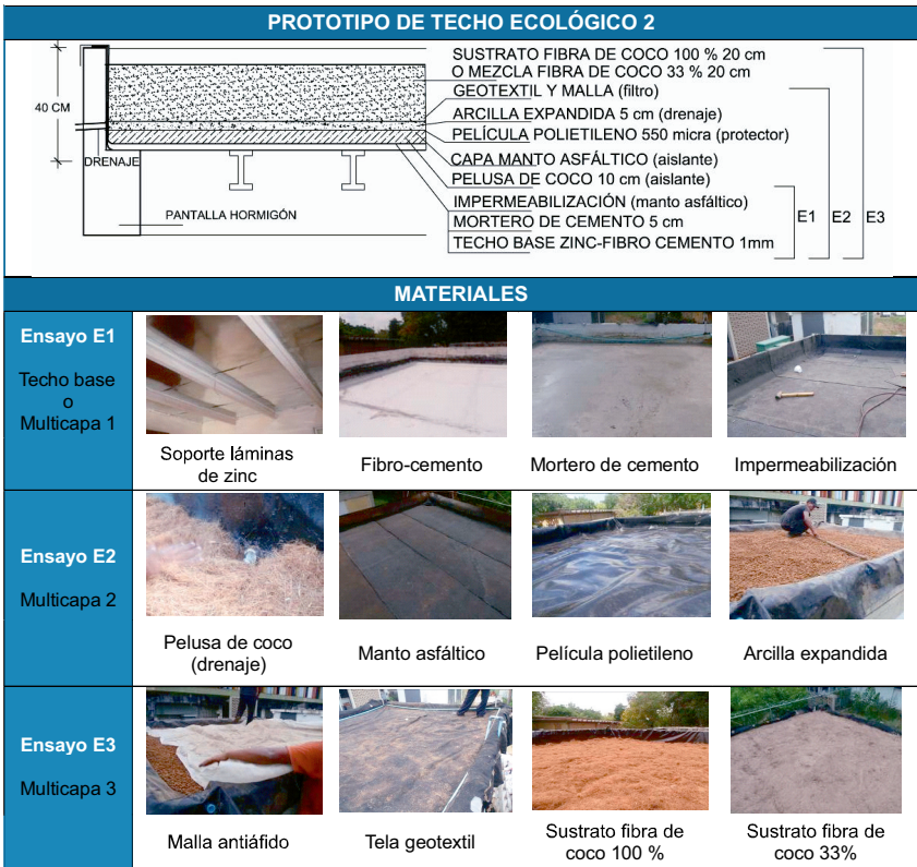
FIGURA 3. Configuración de prototipo de techo ecológico 2 Fuente: Elaboración propia (2015).
