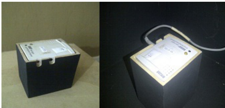
FIGURA 1. Base para dataloggers a la altura del plano de trabajo en el modelo a escala.
