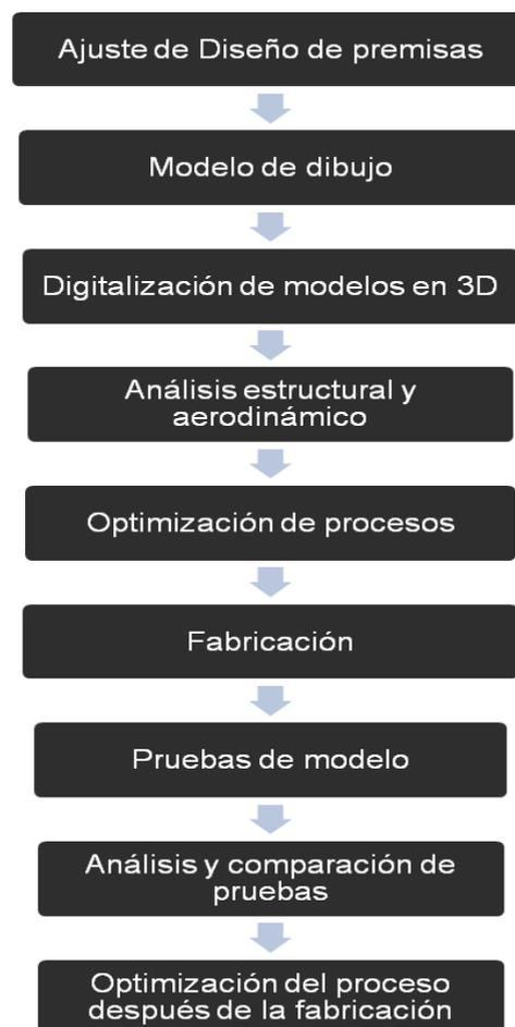
Figura 1. Recorrido para el diseño y construcción del vehículo
