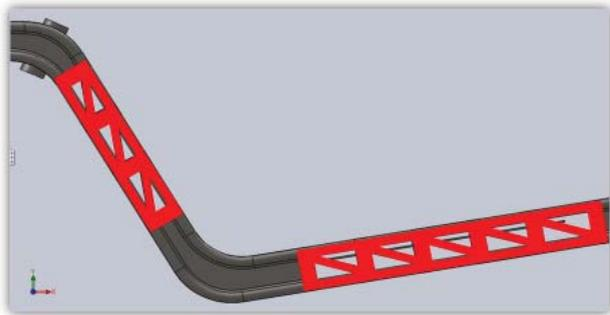
**Figura 2. Configuración del entramado de Howe del chasis.**
