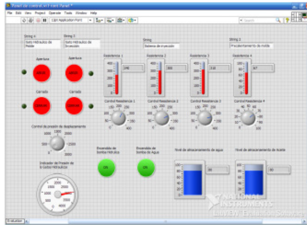
Figura del Panel de control de la máquina. Fuente: Programa Labview (2015)
