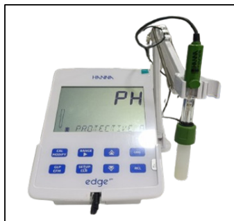
Figura VII: Titulación y medición del pH de la harina de ñame
