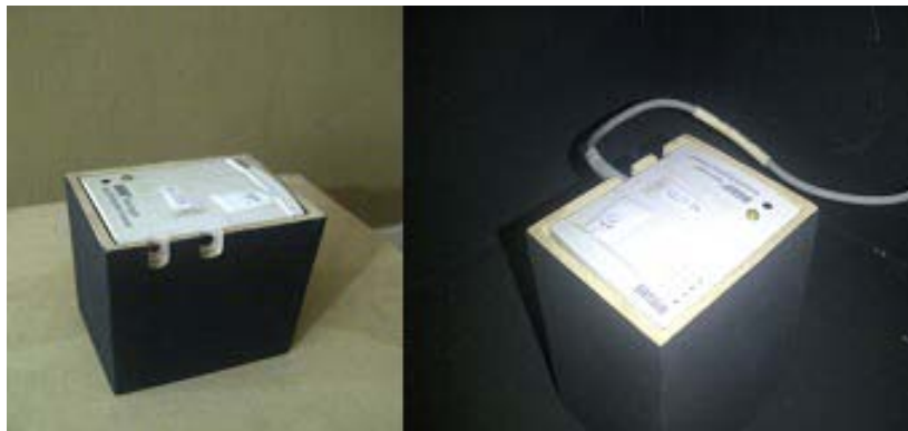
Figura 6. Base para dataloggers a la altura del plano de trabajo en el modelo a escala. Fuente: R. González, septiembre, 2014.
