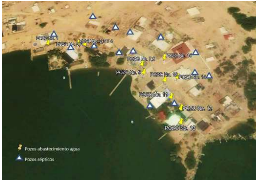
Figura 2. Ubicación de los pozos de agua y sépticos en la isla San Bernardo.
