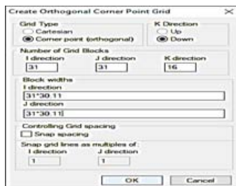
FIG. 8. Ventana de diseño del mallado del reservorio.
