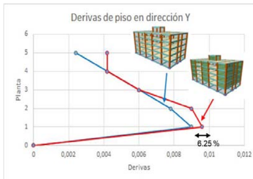
Figura 13. Derivas dirección de sismo "Y" Elaboración propia, adaptado Cypecad (2017)
