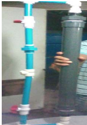
Figura 4. Construcción del Dispositivo de Purificación de Agua
