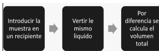
Figura 11. Esquematización del método de inmersión
