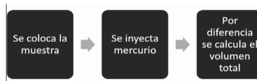
Figura 10. Esquematización del método del picnómetro
