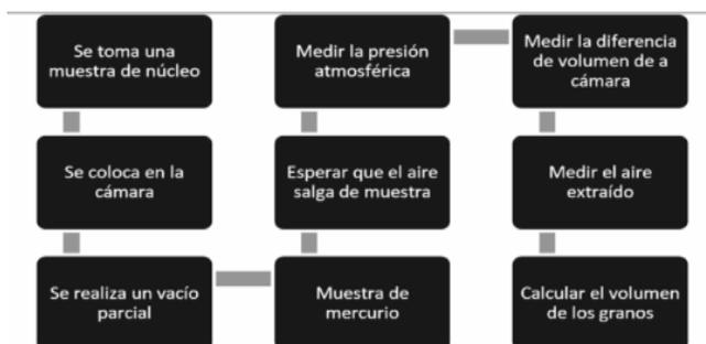
Figura 8. Esquema procedimental del método de vacío
