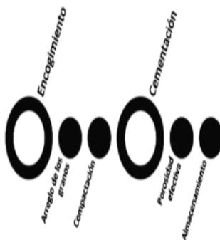
Figura 2. Esquematación de los factores que afectan la porosidad
