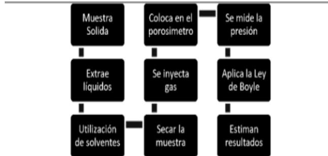
Figura 6. Esquema procedimental del porosímetro de Boyle
