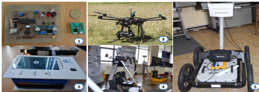
Figura 1: Equipos de alta tecnología proyectos de investigación 1: Circuito electrónico radiómetro diseñado por el IEE; 2: Radiómetro construido por el IEE; 3: Hexacóptero con cámara pruebas de adquisición de datos multispectrales; 4: Resistivímetro; 5: Georadar
