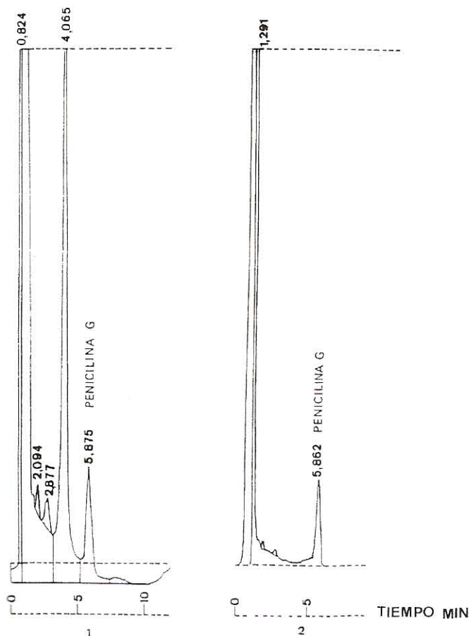
FIGURA 5. CROMATOGRAMAS DE LOS DIFERENTES TRATAMIENTOS DE EXTRACCIÓN APLICADOS A UNA MUESTRA DE LECHE CON 5 µg/mL DE PENICILINA G: AGUA-ACETONITRILLO (CROMATOGRAMA 1), FOSFATO DIACIDO DE AMONIO-METANOL (CROMATOGRAMA 2).
