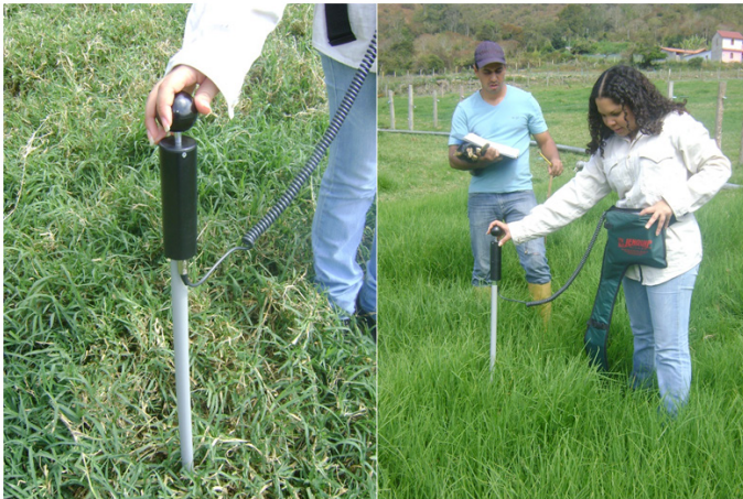
Figura 1. Medidor de capacitancia electrónica Pasture Probe-Jenquip®.
