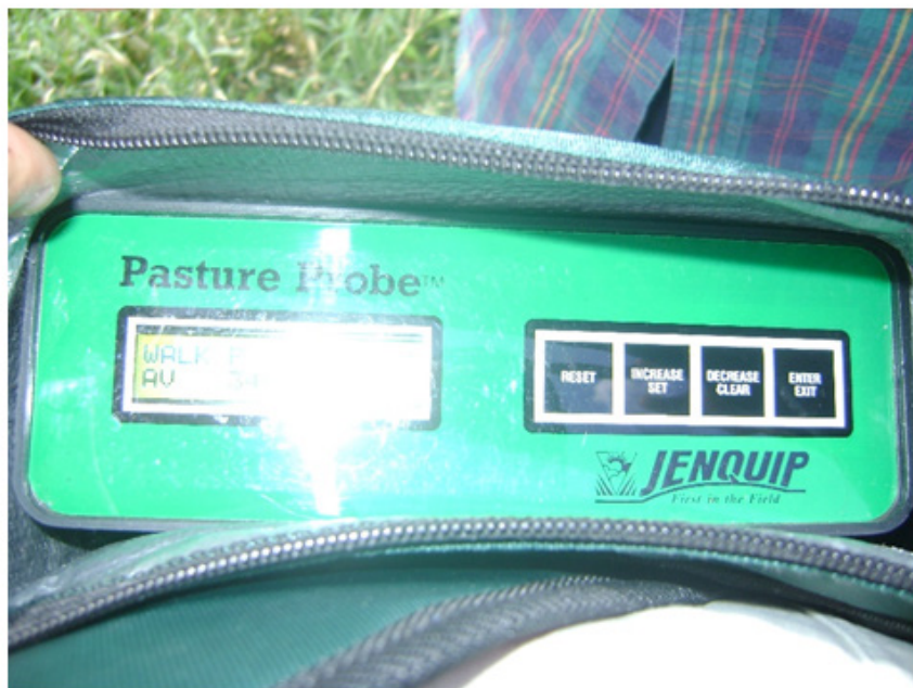
Figura 2. Microprocesador portátil del medidor de capacitancia electrónica Pasture Probe-Jenquip®.
